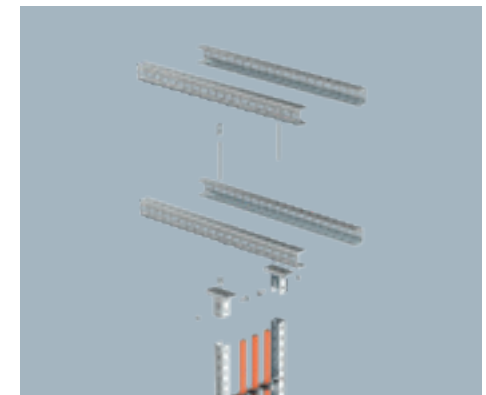
Deckenbefestigung mit Kopfplatten an rechtwinklig angeordneten U-Profilen Ceiling mounting with head plates on profiles arranged at right angle
