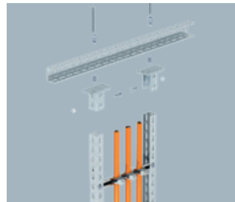
Deckenbefestigung mit Kopfplatten an quer angeordneten U-Profilen Ceiling mounting with head plates on transversely arranged profiles
